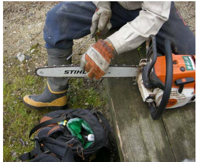
径が大きいために 45 センチのバーを使用
