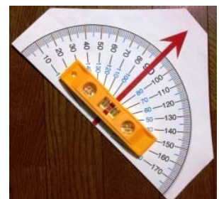
↑ 受け口の方向と水平を分かりやすく するため作って見た分度器
